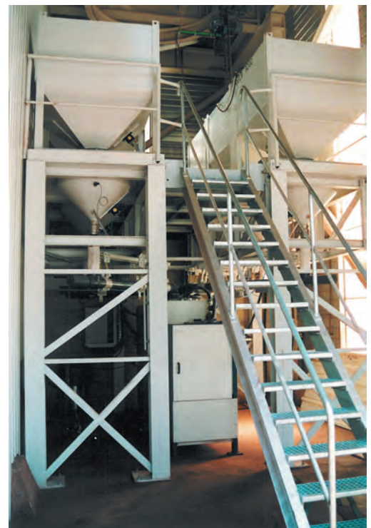
▼ COM 70-3 Granulatdosieranlage mit 3 Sendebehältern für 6 Farben in 3 Mischer. Niedrige Bauhöhe mit Wechselcontainer GC 1500
