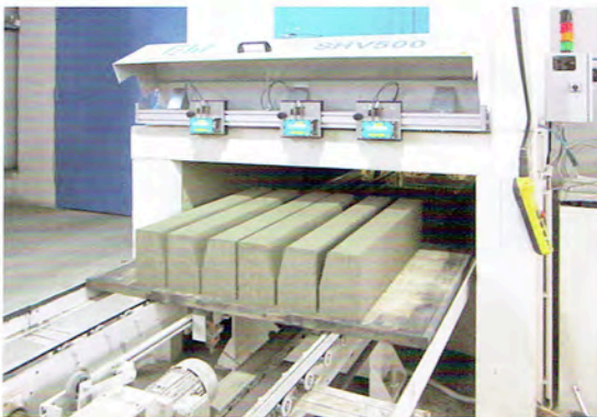
Steenhoogtemeting van trottoirbanden
