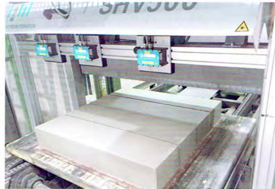
Steenhoogtemeting van traptreden
