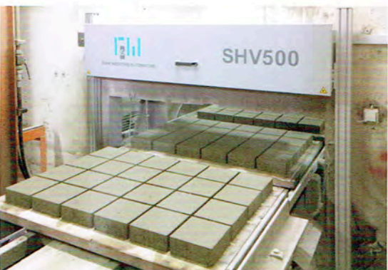
Steenhoogtemeting als smalle opbouw dicht tegen een muur gemonteerd
