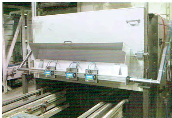
Steenhoogtemeting hefbaar voor het verwisselen van vormen
