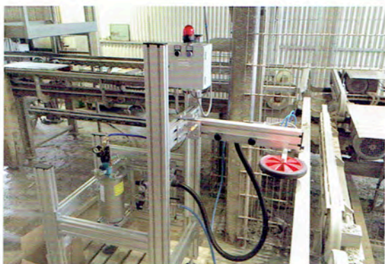
Steenhoogtemeting met vermarker
